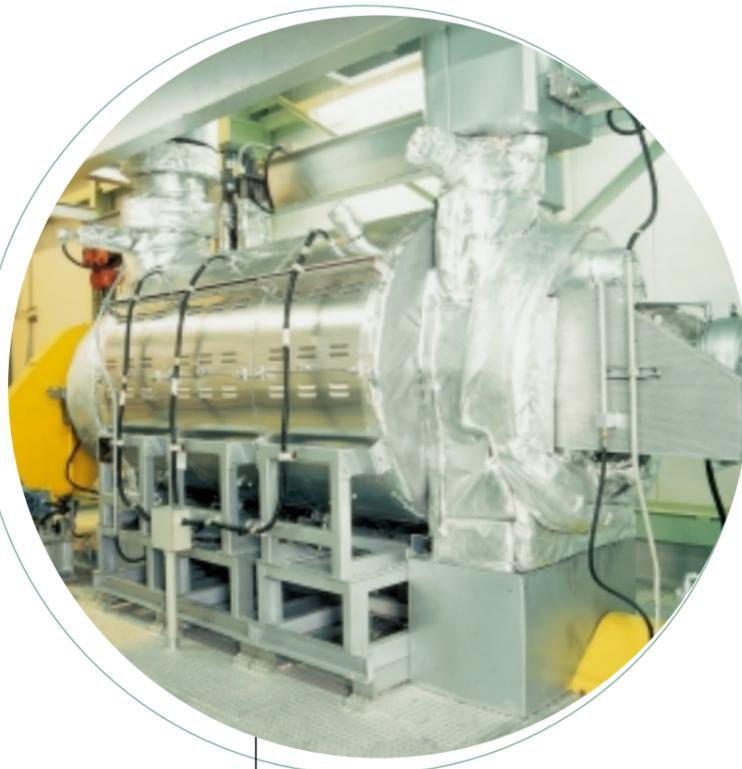
6：飛灰加熱脱塩素化装置用ヒータ
